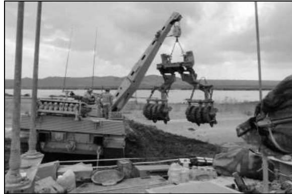
Gauche: Le ARV BRUTUS en pleine action sous la supervision du sergent de maintenance de l'Escadron de chars. Droite: Le ARV CALGARY récupère les rouleaux de déminage de T33 engloutis complètement dans la boue près de Sperwan Ghar. (Photos par le capt P. Croteau)
