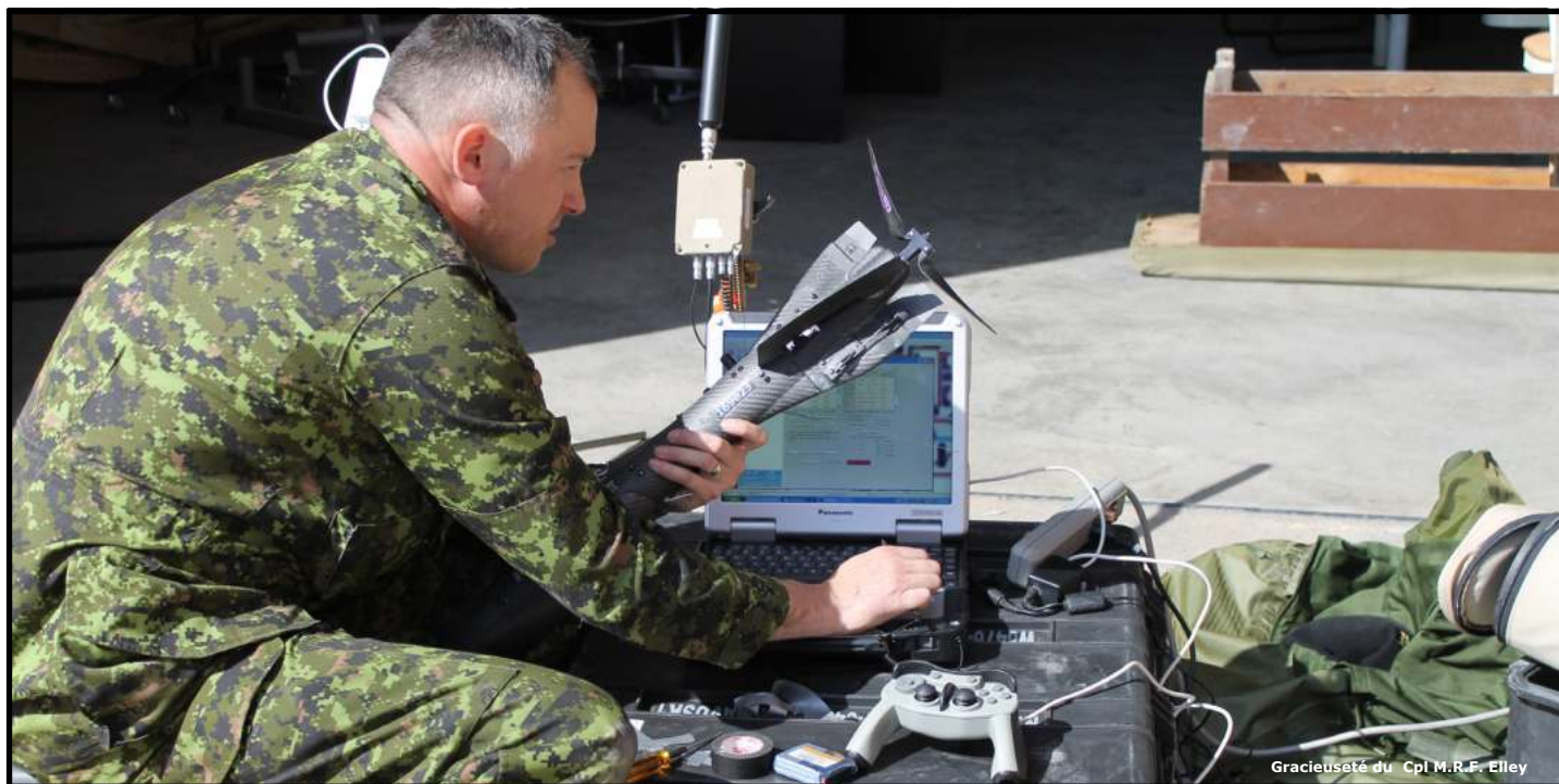
Gracieuseté du Cpl M.R.F. Elley Le Sergent Jason Ellsworth effectue des réglages de dernière minute avant de lancer son mini UAV (Mini Unmanned Aerial Vehicle) Maverick en quête d'une « vue à vol d'oiseau » du terrain lors d'une opération d'instruction à la BFC Gagetown. Rapide et simple à manœuvrer, le mini-UAV peut fournir des renseignements en temps quasi réel aux commandants à des fins de planification.
