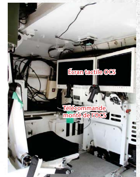
installation principal de la station de contrôle de l'Opérateur (OCS)
