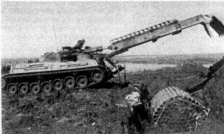
Le Cpl/C Bill Kayden du 22 Fd Sqn utilise son VBG afin de franchir le fossé antichar.
