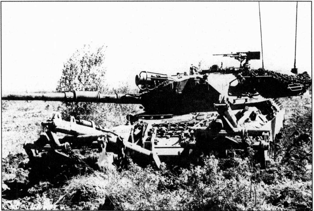
Le léopard équipé de rouleaux de déminage de la largeur d'une chenille. Cela vaut-il la peine?
