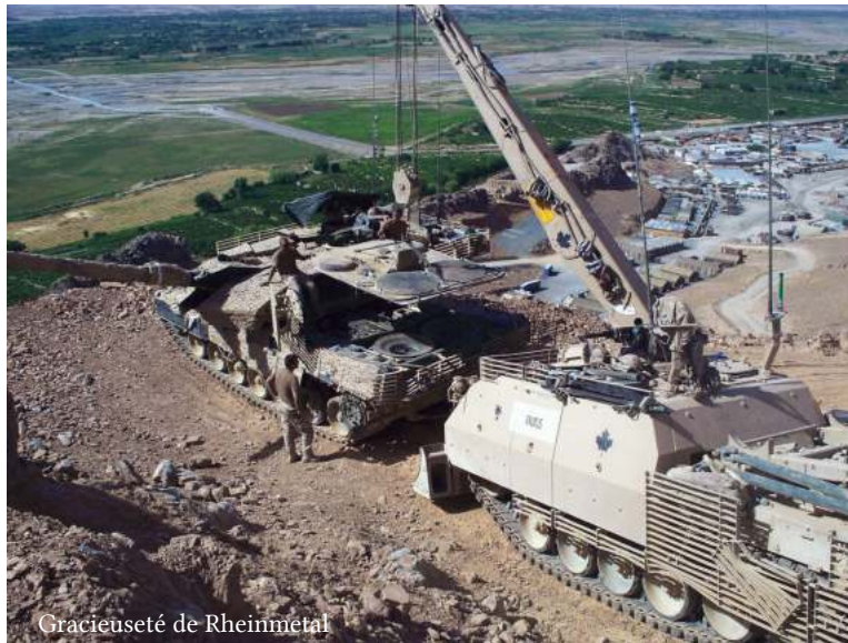
Gracieuseté de Rheinmetall VBD Léopard 2 supportant la maintenance sur le moteur d'un Léopard 2 dans une base d'opération avancé en Afghanistan.
