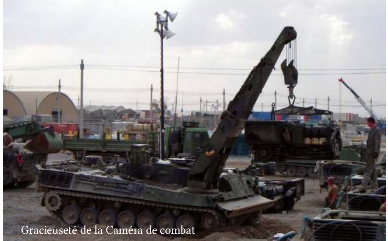
VBD Léopard 1 levant un bloc moteur en Afghanistan.
