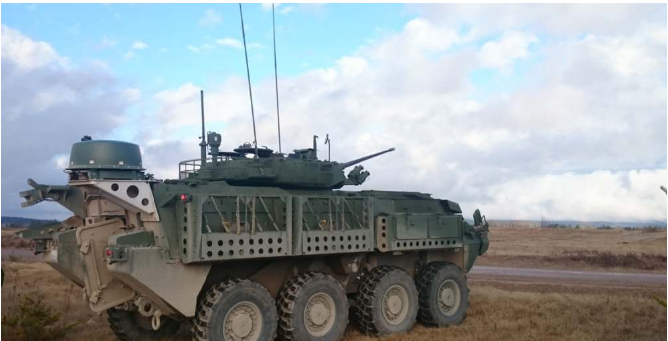
Installation d'un prototype d'antenne de SOTM sur un VBL 6.0
